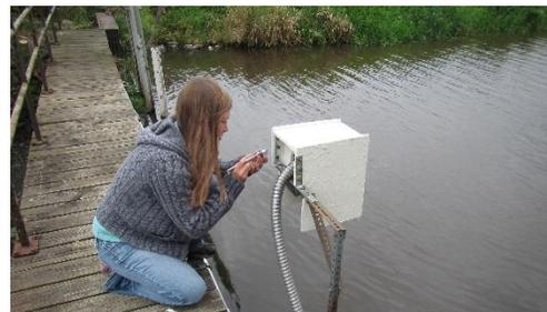
**FIGURE 9 STAFF INSTALLING SOLAR SHIELD ON ULTRASONIC DISTANCE SENSOR**
